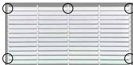
マグネット用プレート取付位置例（縦枠の裏側）
